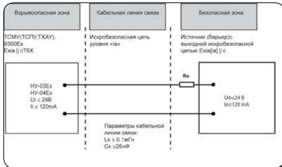
**Рис.5** Схема внешних соединений термопреобразователей взрывобезопасных исполнений
