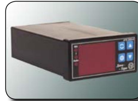
ИТВ предназначен для измерения температуры и влажности в различных технологических процессах химической, перерабатывающей промышленности; в производстве и хранении продуктов питания; в машиностроении, энергетике и пр.. В качестве первичных датчиков температуры используются полупроводниковый датчик Pt 100 В качестве датчика влажности используется датчик емкостного типа.
