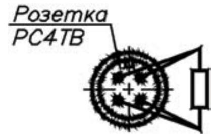
Рис.1. Вид со стороны распайки кабельной розетки.
